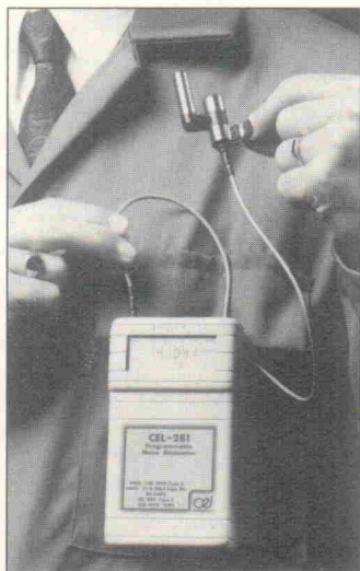
Bild 6. Die klassische Anwendung eines Lärm-Dosimeters: hier wird das Produkt aus Pegel und Zeit gebildet (Modell 281 von Lucas).
